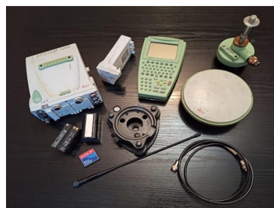
Рисунок 10 – Мобильный GPS-приемник Leica ATX1230 + GNSS (слева) и базовая станция Leica GX1230+GNSS (справа) в разобранном виде
