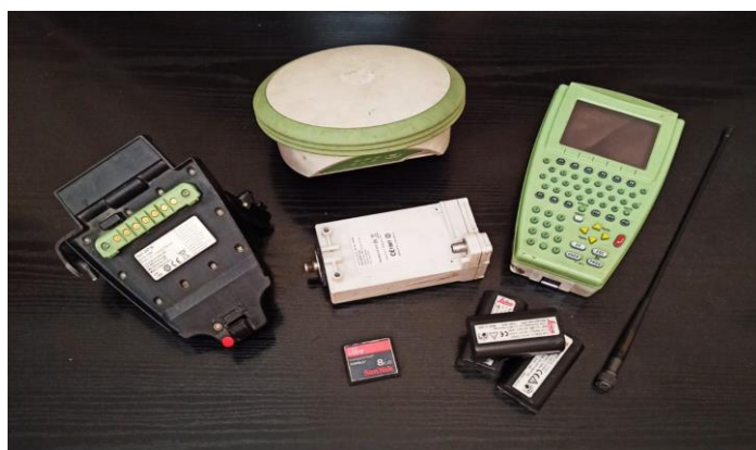
Рисунок 10 – Мобильный GPS-приемник Leica ATX1230 + GNSS (слева) и базовая станция Leica GX1230+GNSS (справа) в разобранном виде
